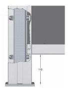
Wenn Sie den Pfosten Typ C so einsetzten, dass Sie eine "schmale, gerade Nut" und eine "Winkelnut" für die Montage zweier Sichtblenden verwenden, müssen Sie Aussparungen für die Sechskantmuttern/ Schraubenköpfe der Pfostenankerschrauben in Ihre Sichtblendenprofile schneiden.
